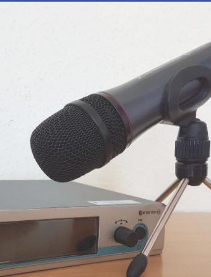
Transmitter und Mikrofon der FM-Anlage
